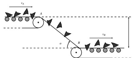
On suppose que l'analyse se fait dans le référentiel terrestre considéré galiléen. Le fonctionnement normal de l'ensemble est assuré si la vitesse du second tapis est exactement identique à la vitesse des blocs arrivant à sa hauteur.
